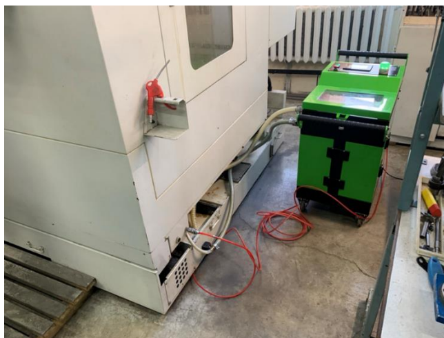
Рисунок 2. Размещение УО СОЖ около станка №4
