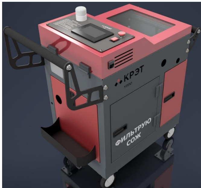
Рисунок 1. Устройство очистки СОЖ АО «УППО»
