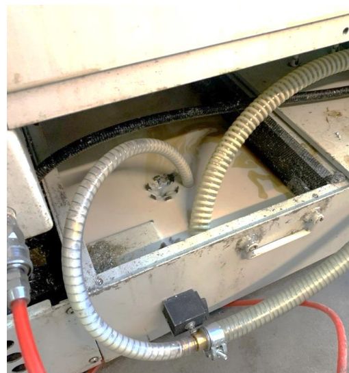
Рисунок 2. Размещение УО СОЖ около станка №4
