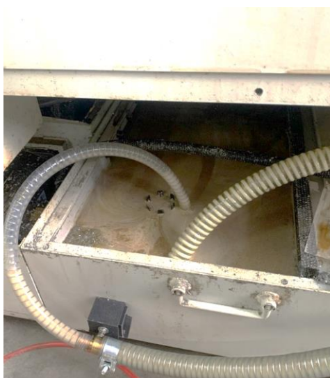
Рисунок 2. Размещение УО СОЖ около станка №4
