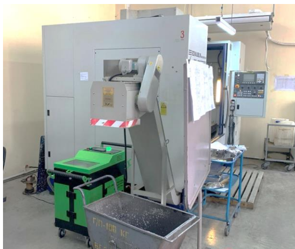
Рисунок 5. Размещение УО СОЖ около станка №3
