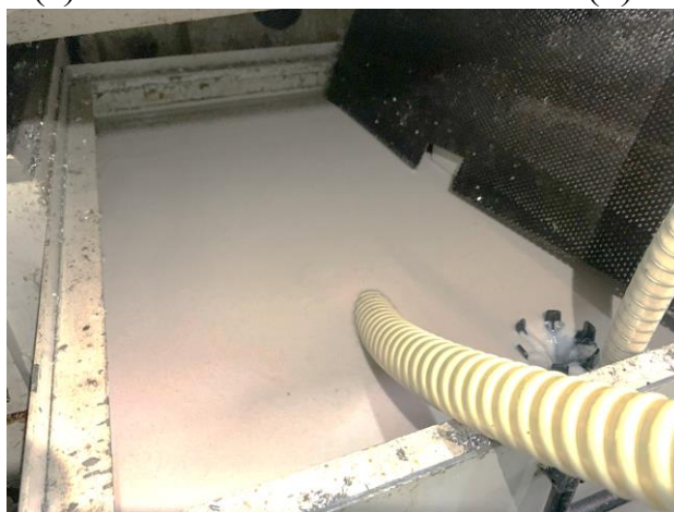
Рисунок 3. Внешний вид СОЖ до начала работ (а), через 20 минут после начала работ (б) и по окончании очистки (в) на станке №4
